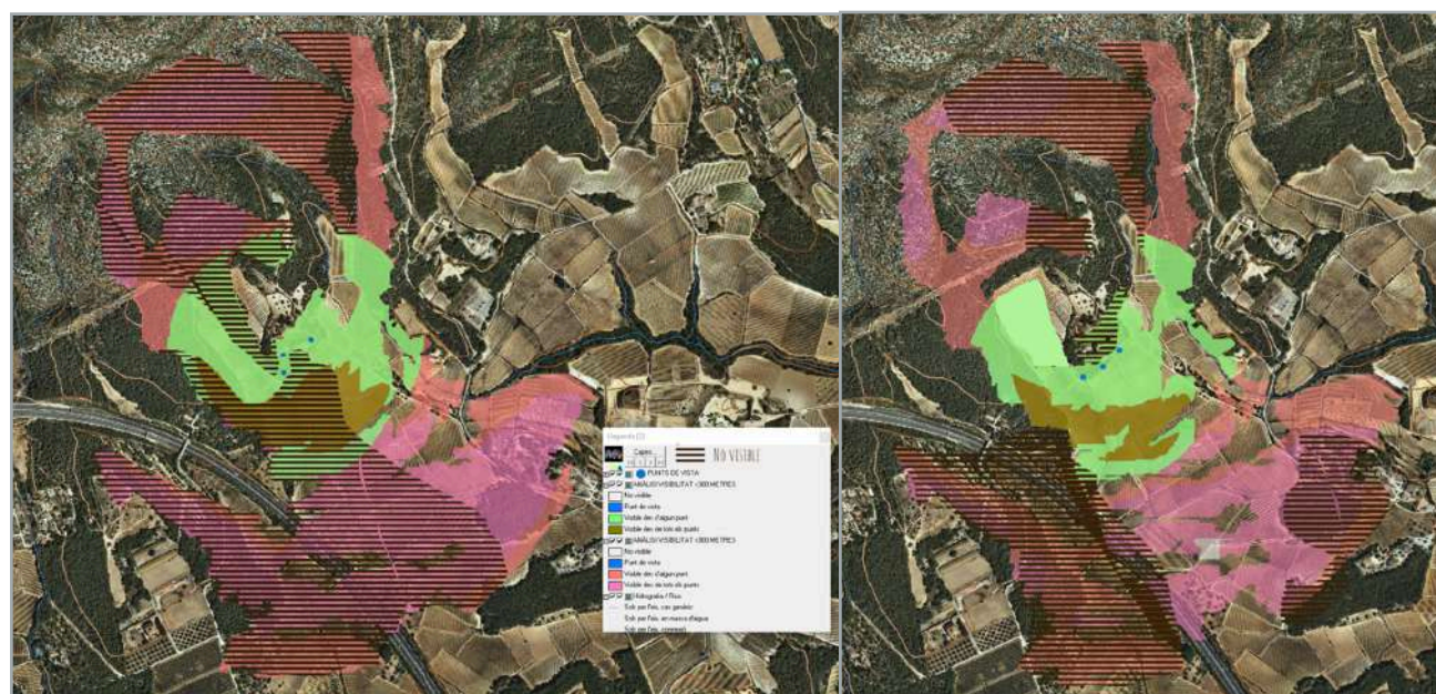
Figura núm.22: Comparació dels d'anàlisi de visibilitat amb dos punts d'observació a la zona d'actuació. Imatge de l'esquerra des de camí actual d'ús públic. Imatge de la dreta des de el traçat on s'ha projectat el nou camí primari (Font: elaboració pròpia mitjançant SIG-MiraMon i Tayasui Sketches Pro)
