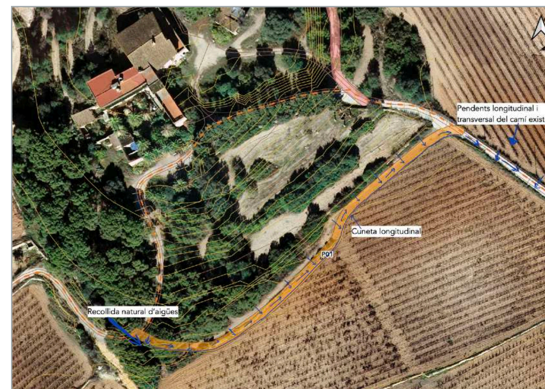
Figura núm.24: Croquis sobre la recollida d'aigües dissenyada en el camí. (Font: elaboració pròpia).
