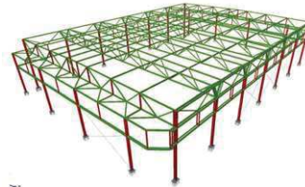
Vista 3D mostrant les encavallades transversals
