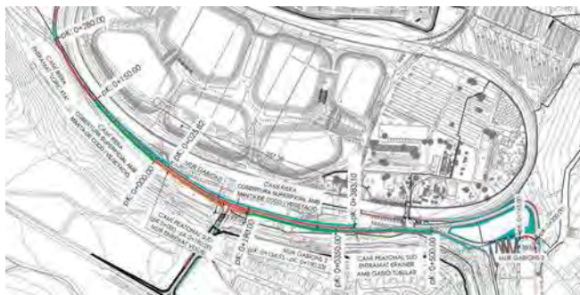
Fig. 4. Plànol de planta del talús de la riera i els murs projectats a la zona sud de l'Autòdrom.
