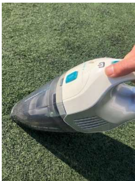
Presca de mostres i recollida de farcits existents per analitzar i punxades al paviment per saber quantitat de reblert que hi ha en aquests moments a la gespa. S'ha observat que la mitjana de reblert existent és d'aproximadament 25mm.
