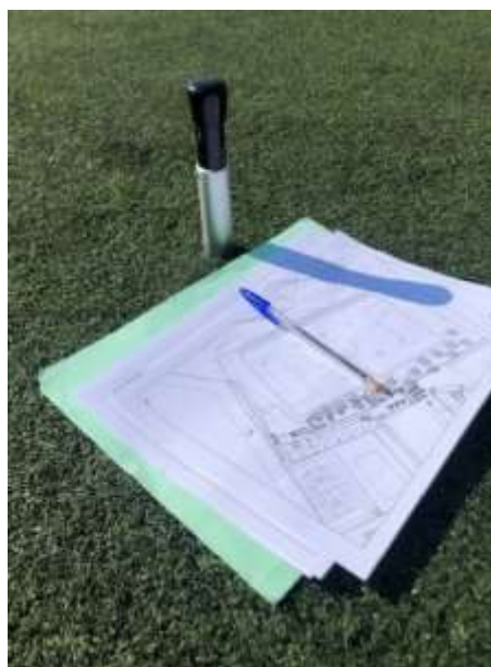
Presca de mostres i recollida de farcits existents per analitzar i punxades al paviment per saber quantitat de reblert que hi ha en aquests moments a la gespa. S'ha observat que la mitjana de reblert existent és d'aproximadament 25mm.
